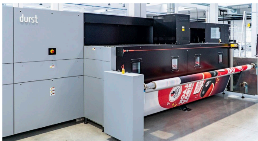
Il tessuto, stampato e sublimato su P5 TEX iSUB è pronto per il taglio e la confezione.
