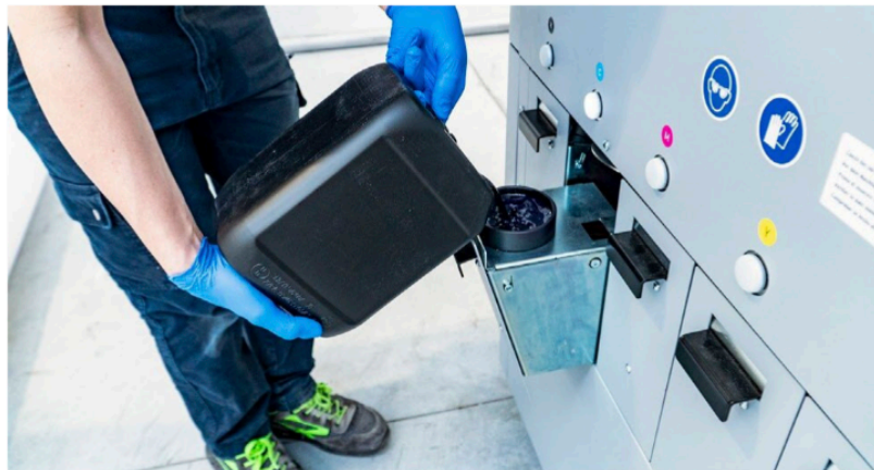
Il sistema di caricamento inchiostri vincola l'apertura del serbatoio alla lettura di un QR code.
