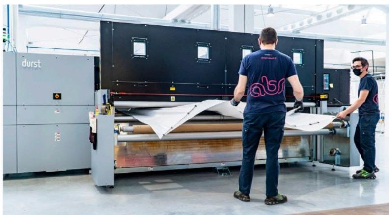
Grazie al design compatto delle unità di stampa e termofissaggio, Durst P5 TEX iSUB semplifica le operazioni di caricamento e riduce del 50-60% il tessuto necessario all'incorsatura.
